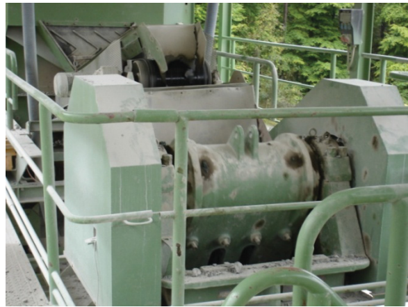
Brecherband (30) und Nachbrecher (31)
