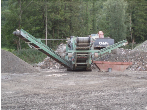
Überkornband; Vorabsiebung; Hauptaustragsband; Magnetband; Siebmaschine
