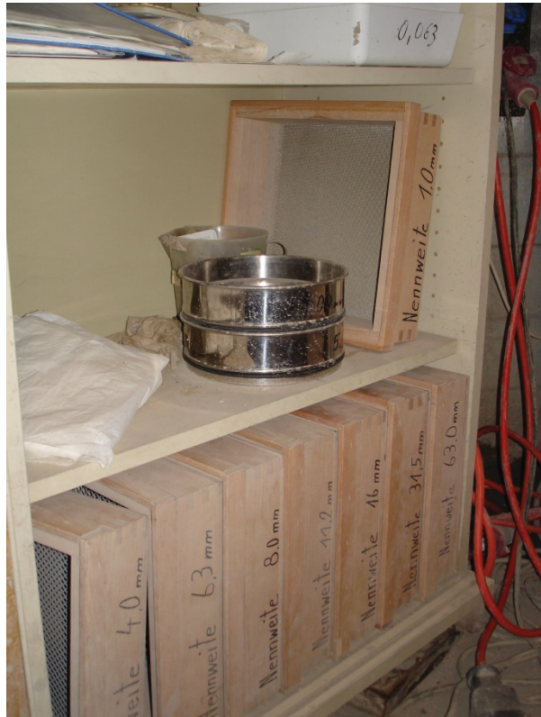
Siebe mit versch. Maschenweiten
