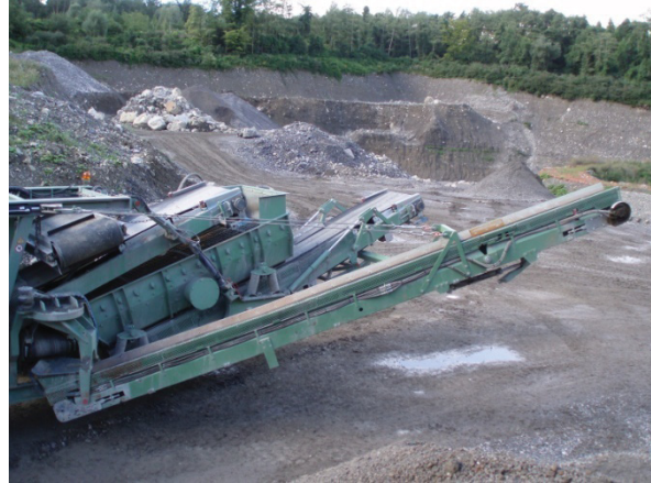
Überkornband; Vorabsiebung; Hauptaustragsband; Magnetband; Siebmaschine
