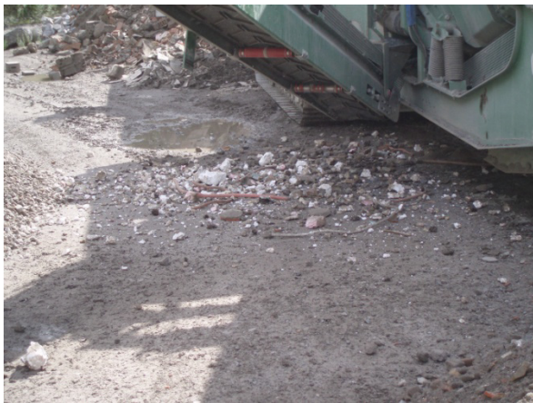
Leichtstoffe unter Überkornband
