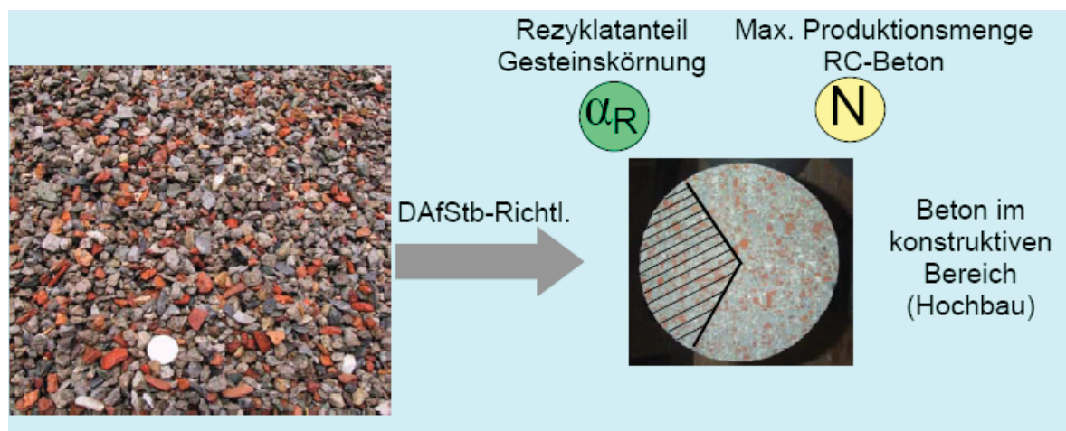
Abbildung 57: Verwendung rezyklierter Gesteinskörnungen im Beton [19]
