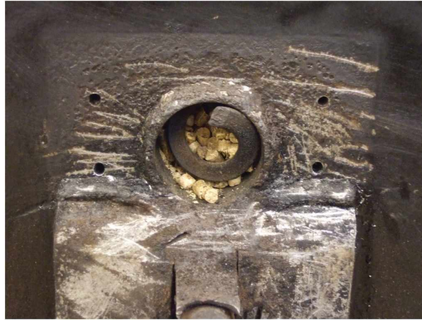
Abbildung 9.3: Positionierung der Primärluftlöcher über dem Brennstoffbett (vier Bohrungen mit 4,2 mm Durchmesser)
