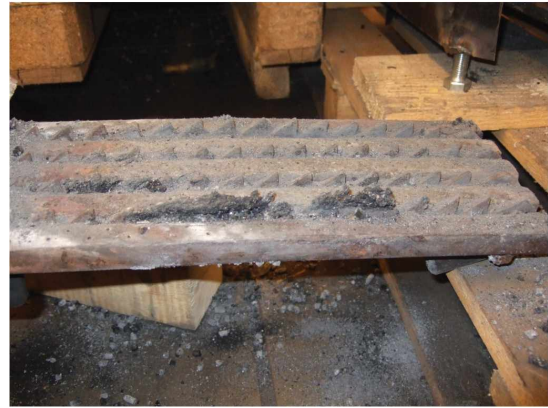
Abbildung 8.6: Verkrustungen auf den beweglichen Roststäben bei einer Primärluftgeschwindigkeit von 1,9 m/s
