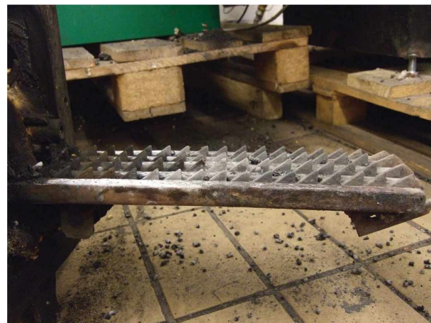
Abbildung 9.8: Rost nach Betrieb der Anlage mit vier 4,2mm Bohrungen in der Rückwand
