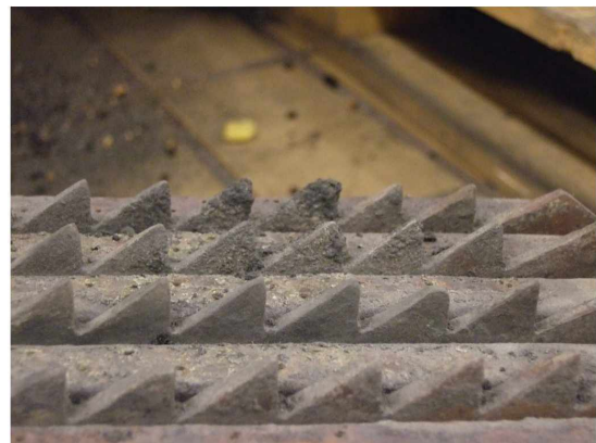
Abbildung 9.6: Verkrustungen auf beweglichen Rechen bei zwei 4,2 mm Bohrungen
