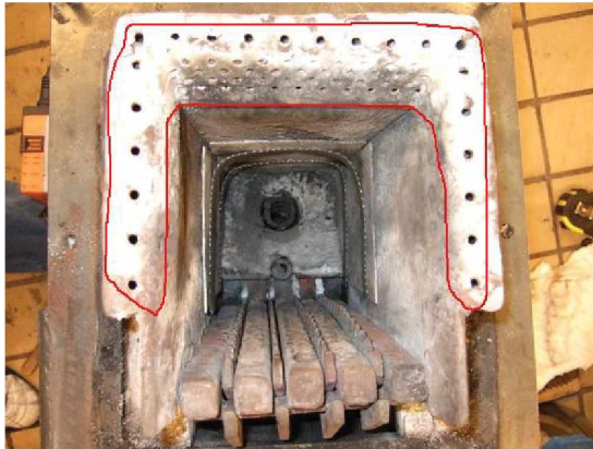
Abbildung 6.3: Sekundärluftöffnungen am Ende des Brennerteils
