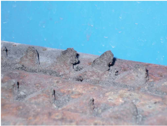
Abbildung 8.5: Verkrustungen auf den beweglichen Roststäben bei einer Primärluftgeschwindigkeit von 1,7 m/s
