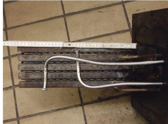
Abbildung 9.12: Eingebaute gewundene Primärluftdüsen und 35 mit Nägeln geschlossene Rostlöcher
