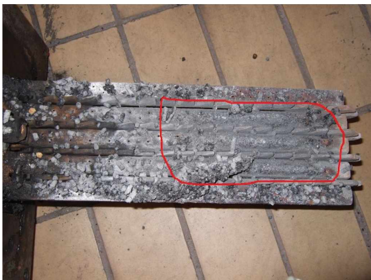
Abbildung 9.5: Verkrustungen auf unbeweglichen Roststäben bei zwei 4,2 mm Bohrungen
