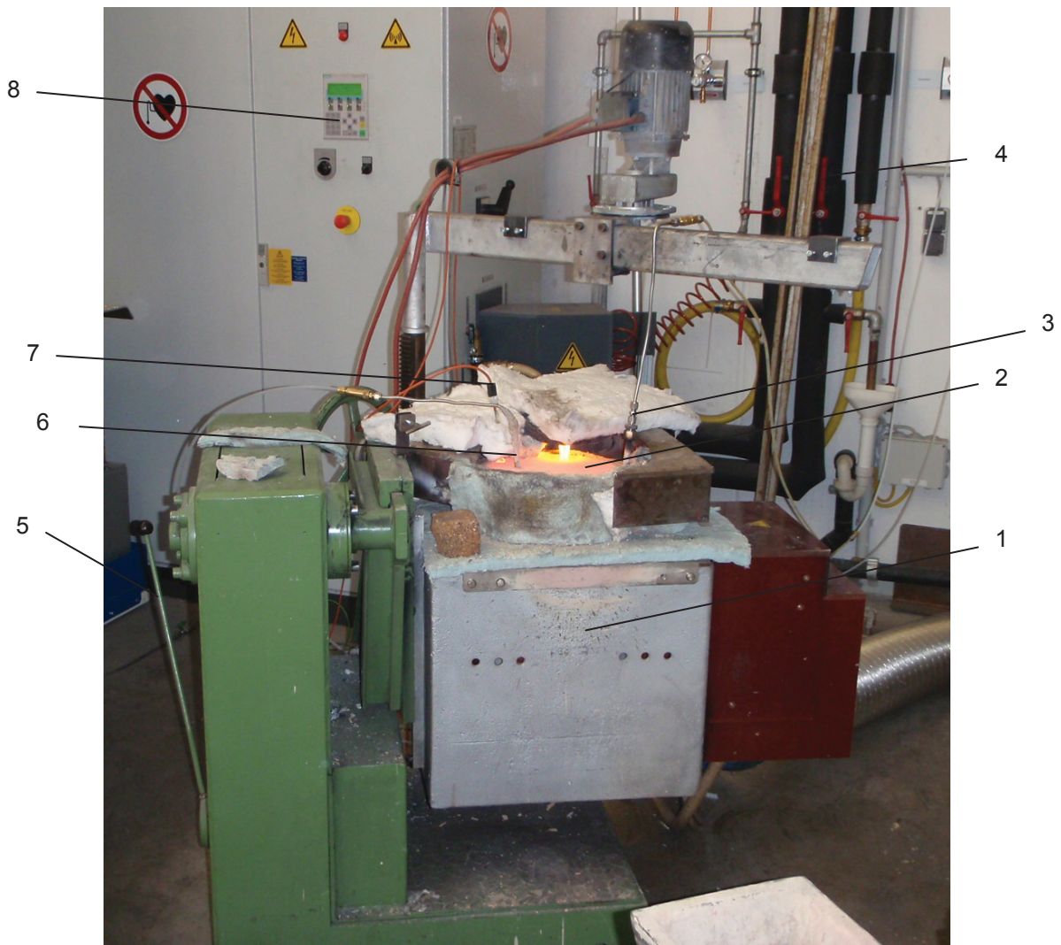
1. Ofenraum, 2. Deckel, 3. Stickstoffversorgung, 4. Kühlwasserzufuhr, 5. Kippvorrichtung, 6. Argonzufuhr, 7. Thermolement, 8. Steuereinheit
