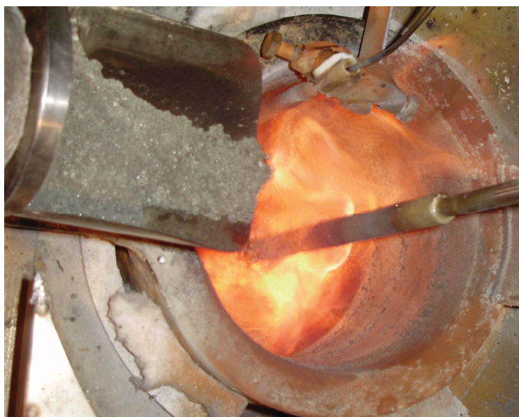
Abb. 5.4: Portionsweiser Chargiervorgang der Schwefel-Grafit-Mischung
