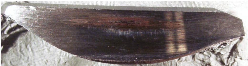
Abb. 9.5: elliptische Bruchkante durch Spannungsverlagerung nach dem Anriss
