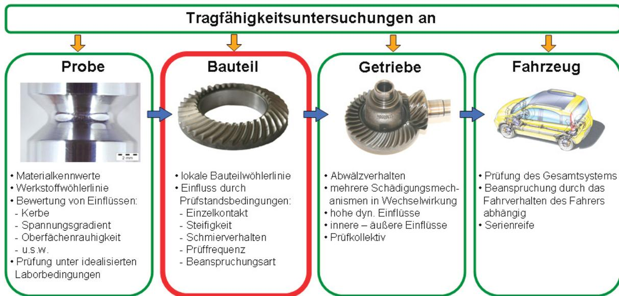
**Abb. 4.5:** Unterschiede der einzelnen Charakterisierungsstufen für eine Hypoidverzahnung
