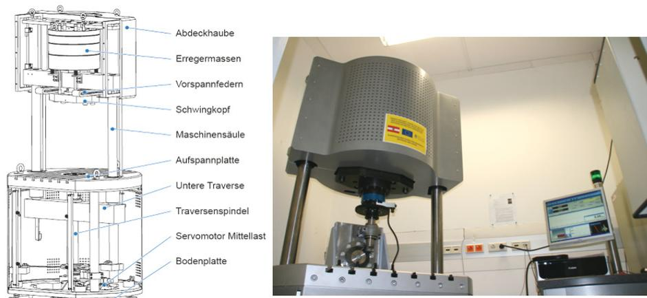
Abb. 5.13: Resonanzprüfstand SincoTec: POWER SWING MAG 150kN [27]
