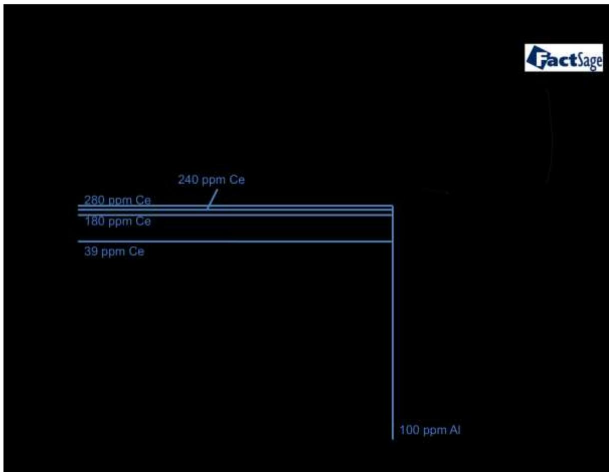
**Abbildung 6-1:** Gemessene Al- und Ce-Werte dargestellt in einem Fe-Ce-Al-O-S Phasendiagramm bei 1600 °C (gerechnet mit FactSage 7.0)
