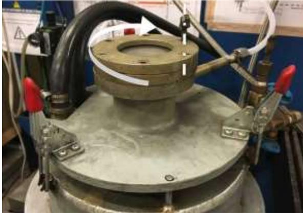
**Abbildung 5-3:** Deckelkonstruktion mit Schwenkfunktion der ersten sieben Versuche
