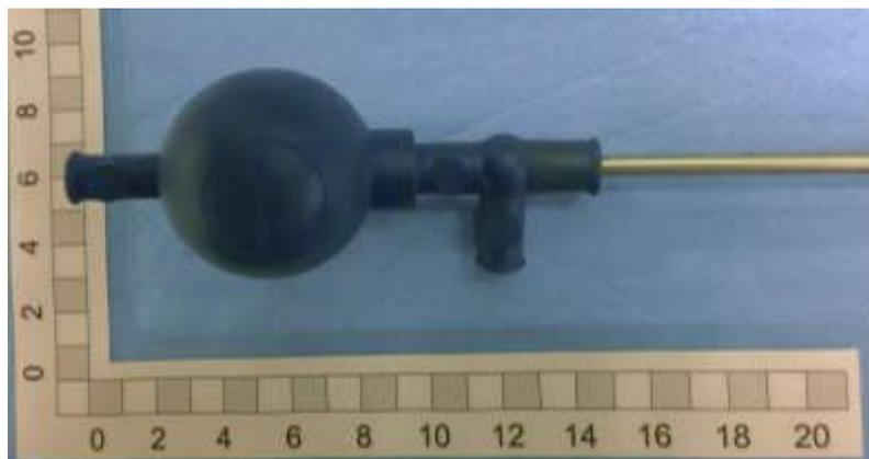
Abbildung 5-11: Rohr mit Peleusball für die Probenahme
