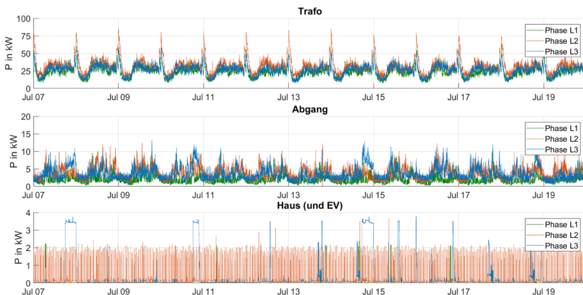
Abbildung 4-6: Aufbereitete Messergebnisse für Trafo (M1), Abgang (M2) und Haushalt (M3) innerhalb der Simulationsperiode
