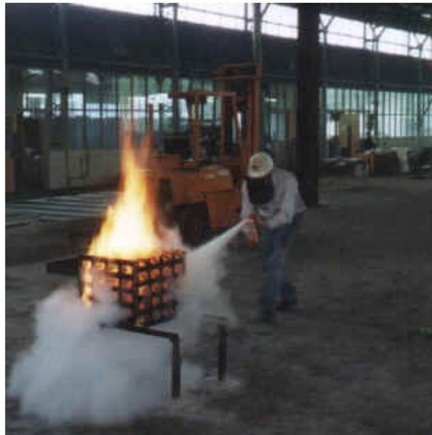
Abbildung 1: Erprobung eines Feuerlöschers an einer Normholzkrippe
