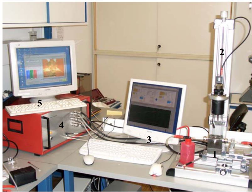
Abbildung 3.1: Aufbau der HTT: (1) Ofen mit Heizelementen, (2) Stativ inkl. Kamera und Objektiv, (3) Regelungssoftware, (4) Regeleinheit und (5) Bildaufzeichnungseinheit [48]
