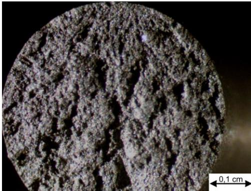
**Abb. 4.44** Limi Aufnahme der Bruchfläche der bei 700°C für 100h oxidierten SD Probe 16.2\_2-1 (EB), gezogen bei RT.
