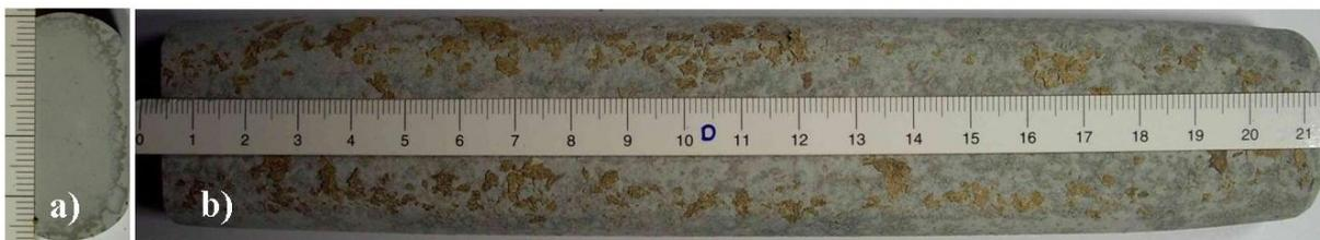
**Abb. 3.2 a) Quer- und b) Längsansicht des D wärmebehandelten Pancakes.**
