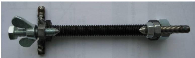
Abb. 3.11 Probenhalter für die Oberflächenanalyse.
