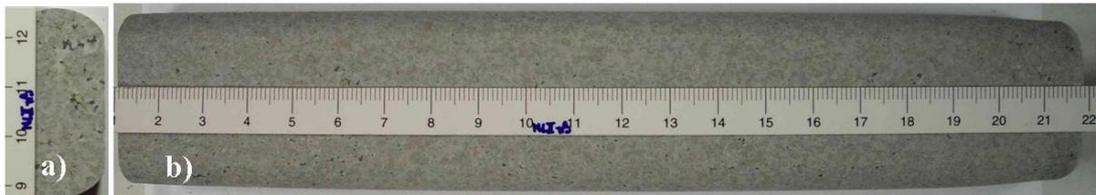
**Abb. 3.1 a) Quer- und b) Längsansicht des NLII+ $\beta$  wärmebehandelten Pancakes.**
