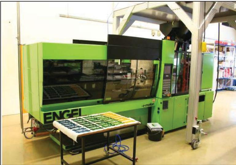
*Abbildung 3: HTS-Anlage mit vollelektrischer Mehrkomponenten-Spritzgießmaschine e-motion 200H200W/100 Combi*
