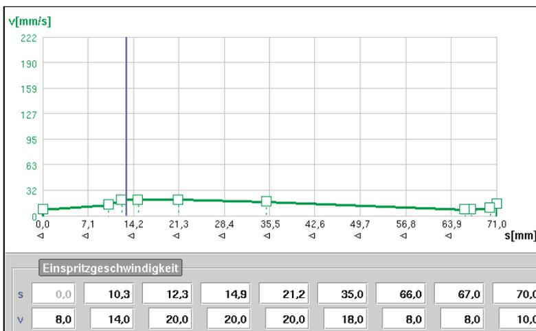
Abbildung 31: Einstellung der Einspritzgeschwindigkeit bei Abfahren eines Profils
