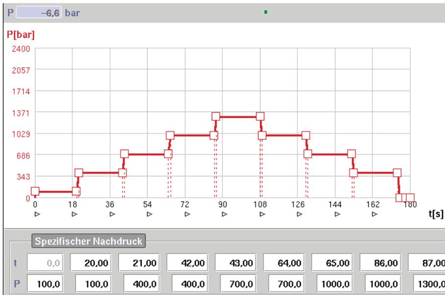
Abbildung 70: Druckprofil zur Untersuchung der Drucksensoranzeige bei quasistatischem Druckzustand
