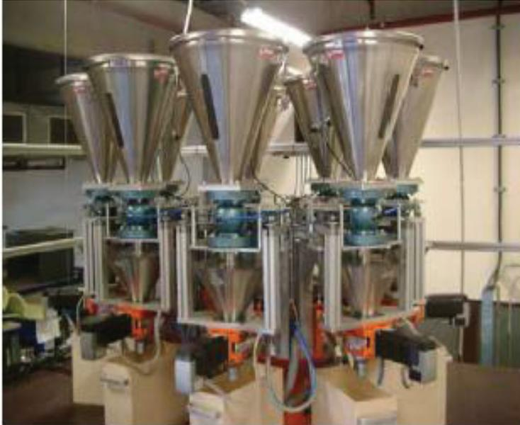
Abbildung 4: Gravimetrisches Dosiersystem Plasticolor [1]
