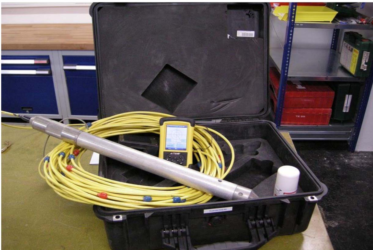
Abbildung 13: Pulsar – Bohrlochvermessungssystem
