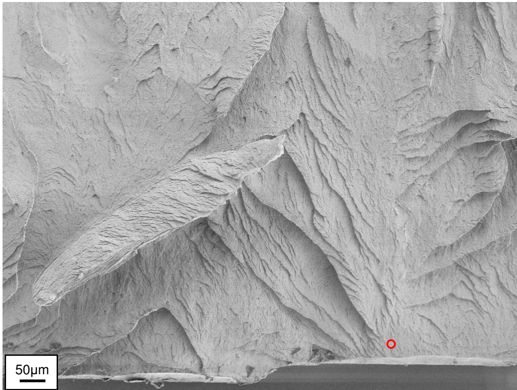
Abbildung 5.46: Diese rasterelektronenmikroskopische Aufnahme zeigt den Bruchausgang der 300nm-Probe aus der Axialrichtung bei einer Prüftemperatur von -196^{\circ}\text{C} . Der Bruchausgang ist in der Abbildung rot markiert, wobei sich der Riss in weiterer Folge trichterförmig ausgebreitet hat ( K_{IC}=21\text{MPa}\sqrt{\text{m}} ).
