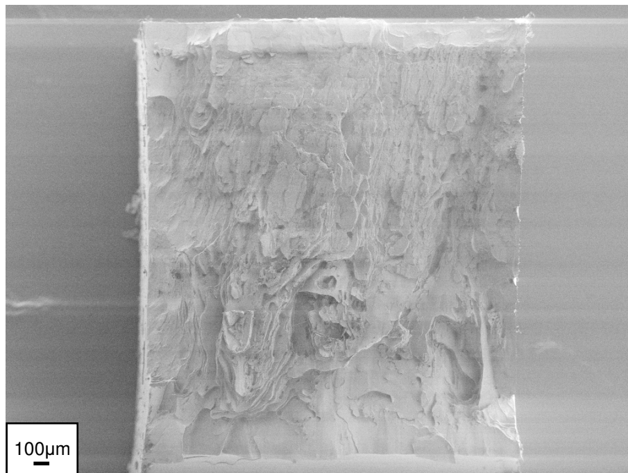
Abbildung 5.7: Rasterelektronenmikroskopische Aufnahme, die die Gesamtbruchfläche der SPD-Probe aus der Scherrichtung bei einer Prüftemperatur von 200 °C zeigt. Auf der Bruchfläche sind beachtliche Scherlippen als Zeichen großer plastischer Verformung erkennbar. Die aus der Kraft-Verschiebungskurve errechnete Bruchzähigkeit beträgt 48 \text{MPa}\sqrt{\text{m}} , ist in Wirklichkeit jedoch weit größer.
