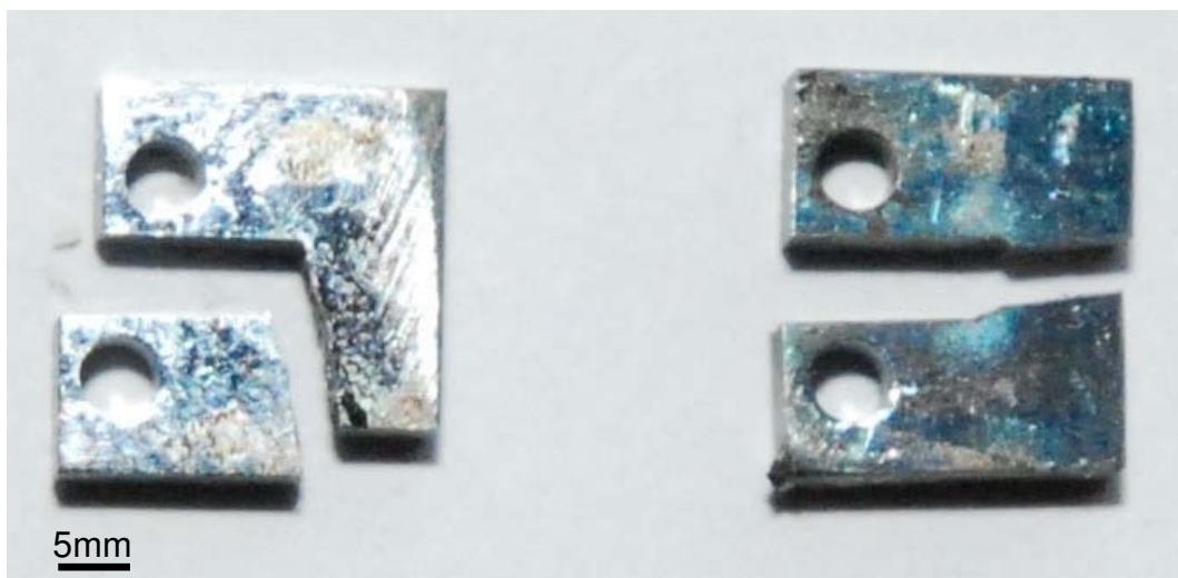
Abbildung 5.35: Die Probe links in der Abbildung ist eine Axialprobe, bei der es während des Bruchzähigkeitsversuches zu einer globalen Rissablenkung kommt. Zum Vergleich ist rechts eine Scherprobe abgebildet, bei der der Rissausbreitungspfad wie erwartet erfolgt.
