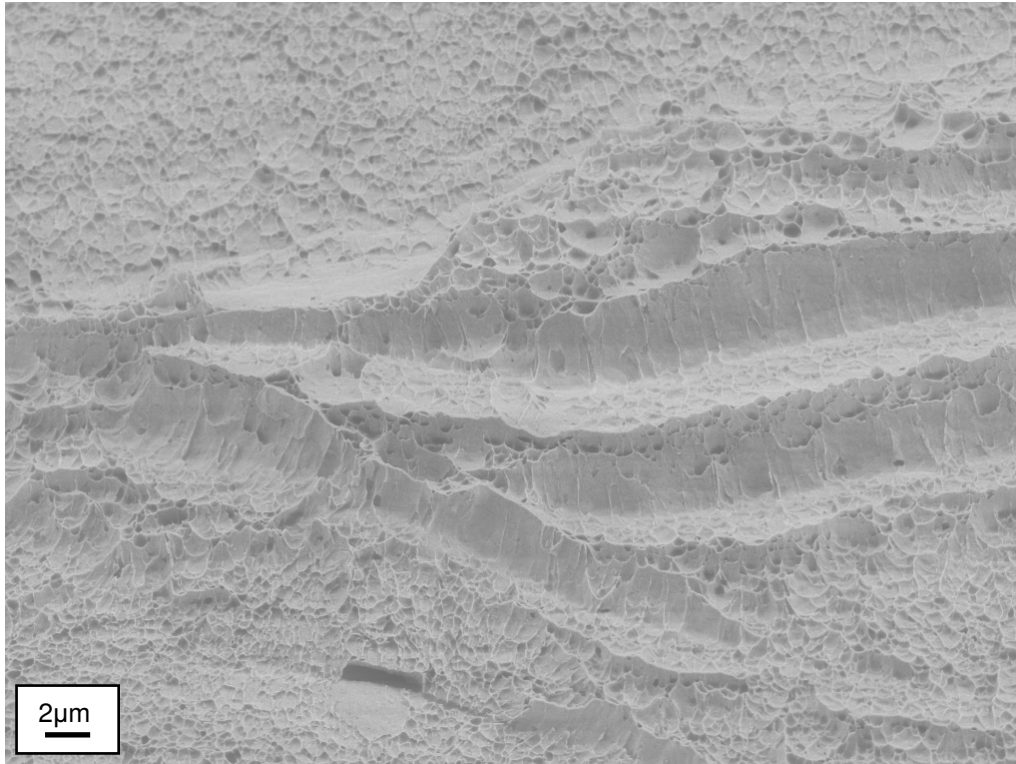
Abbildung 5.50: Diese rasterelektronenmikroskopische Aufnahme zeigt einen Bruchflächenausschnitt derselben Probe. Es ist ein Teilbereich einer axial-orientierten Bruchfläche zu sehen, wobei Dimples als auch ausgezogene Mikrostrukturen als Kennzeichen von duktilem Versagen zu erkennen sind.
