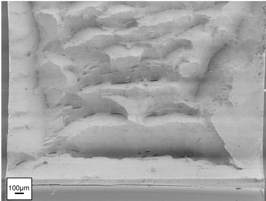
Abbildung 5.49: Diese rasterelektronenmikroskopische Aufnahme zeigt die Bruchfläche der 300nm-Probe aus der Axialrichtung bei einer Prüftemperatur von 200°C. In dieser Aufnahme sind die beachtlichen Scherbruchanteile als Kennzeichen für duktilen Versagen deutlich zu sehen ( K_{IC}=52\text{MPa}\sqrt{\text{m}} ).
