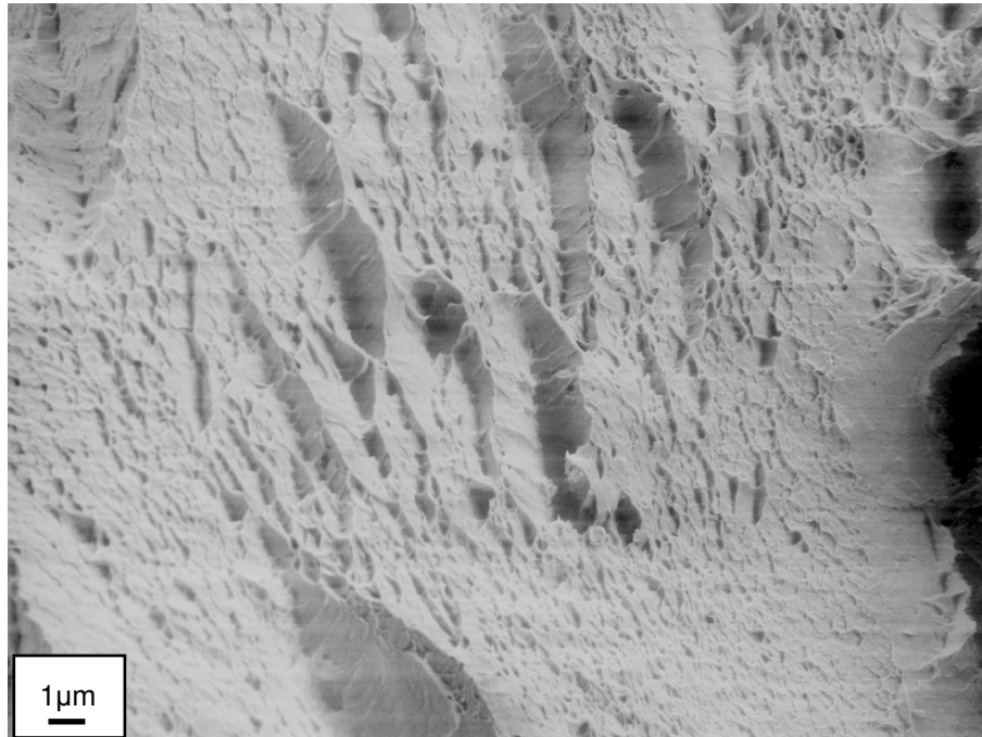
Abbildung 5.72: Diese rasterelektronenmikroskopische Aufnahme zeigt einen Bruchflächenausschnitt der SPD-Probe aus der Radialrichtung bei Raumtemperatur. Der abgebildete Bereich befindet sich in etwa 20µm vor dem Ermüdungsanriss, wobei neben Delaminationen auch Dimples zu sehen sind, die auf plastische Verformung – wenn auch nur in mikroskopischem Ausmaß – schließen lassen. Die für diese Probe errechnete Bruchzähigkeit von 57\text{MPa}\sqrt{\text{m}} ist nur als Schätzwert anzusehen.
