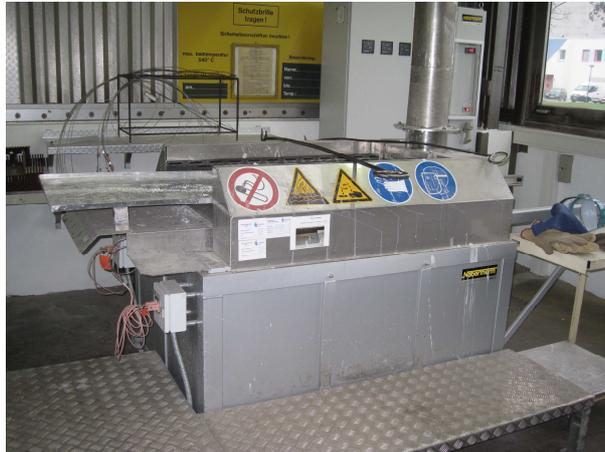
Abb. 97: Aggregat für die Lösungsglühversuche im Salzbad
