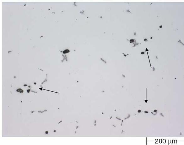
LIM / HF / Querschliff; ungeätzt; Pos. T/4
