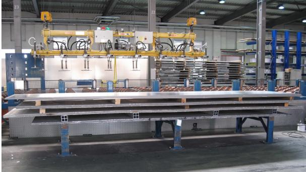
Abb. 79: Warmgewalzte Versuchsplatten
