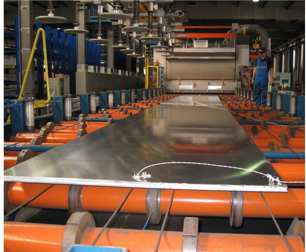
Abb. 80: Lösungsglühofen im Betrieb (Fa. Ebner)
