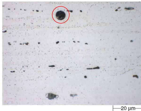
Abb. 107: Gefüge der Legierung 7075.5 bei >> 480 °C
