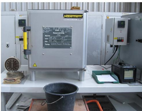
Abb. 74: Laborofen der Fa. Nabertherm - Lösungsglühung
