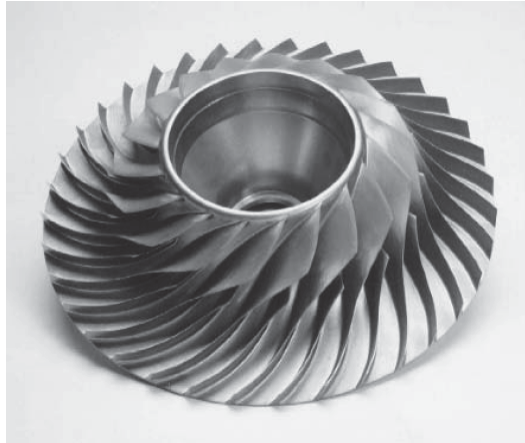
Abb. 13: Verdichter für Regionaljets; Ti 6-2-4-2; bimodale Mikrostruktur [16]
