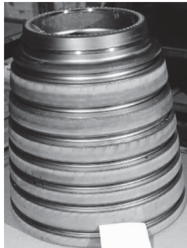
Abb. 12: Verdichterscheiben für das GE CF6 Triebwerk; vordere Stufen: Ti 6-4; hintere Stufen Ti 6-2-4-2 [16]
