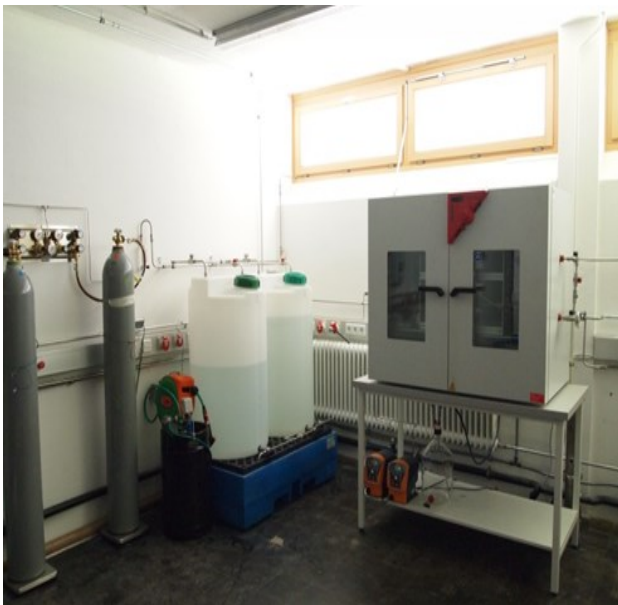
Abbildung 43: Bilder der Flow Loop Versuchsanlage (links: Flüssigkeitsbehälter und Prüfkammer, rechts: Gasmotor und Ölkühlung)
