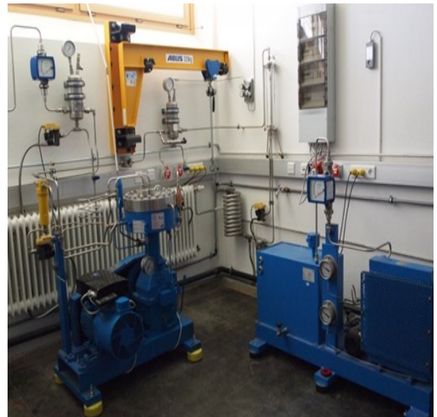
Abbildung 43: Bilder der Flow Loop Versuchsanlage (links: Flüssigkeitsbehälter und Prüfkammer, rechts: Gasmotor und Ölkühlung)
