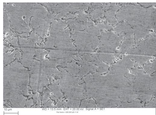
Abbildung 72: Sekundärelektronenmikroskopische Aufnahme einer EPR-Probe, Werkstoffzustand 950\_L
