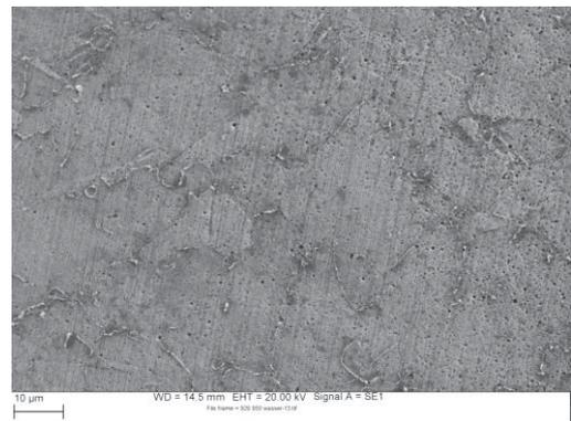
Abbildung 76: Sekundärelektronenmikroskopische Aufnahme einer EPR-Probe, Werkstoffzustand 950\_W
