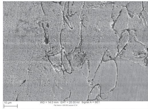
Abbildung 68: Sekundärelektronenmikroskopische Aufnahme einer EPR-Probe, Werkstoffzustand 850\_W
