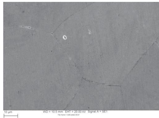
Abbildung 60: Sekundärelektronenmikroskopische Aufnahme einer EPR-Probe, Werkstoffzustand LG
