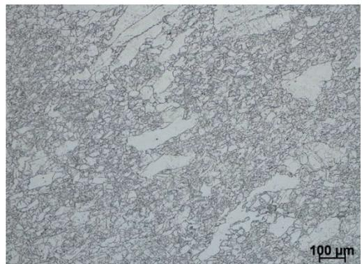
Abbildung 32: Lichtmikroskopisches Gefügebild des Werkstoffzustandes 850\_WA, geätzt mit V2A-Lsg.
