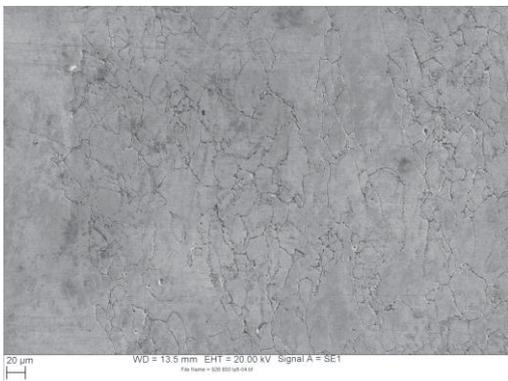
Abbildung 63: Sekundärelektronenmikroskopische Aufnahme einer EPR-Probe, Werkstoffzustand 850\_L
