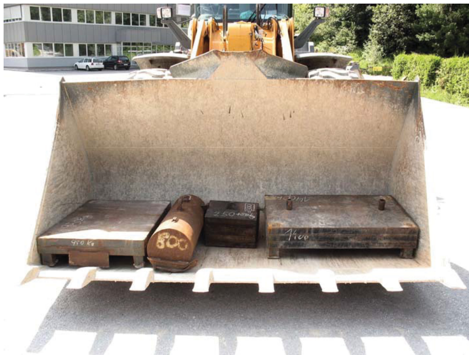
Abb. 3.1: Halbbeladene Schaufel (Stahlgewichte)
