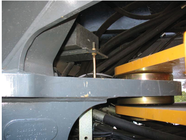
Abb. 4.3: Einbauposition des Tri-Axis-Inertial-Sensors am Hinterwagen
