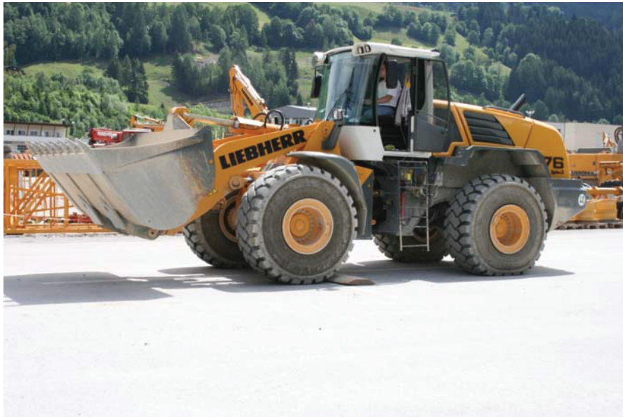
Abb. 3.3: Schwellenüberfahrt mit den Rädern der Vorder- und Hinterachse
