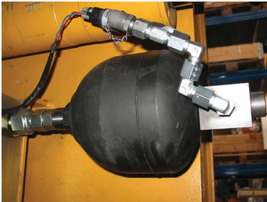
Abb. 4.4: Sensorposition am Membranspeicher
