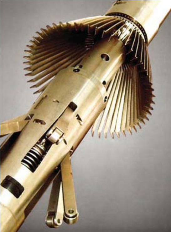
Fig. 43 Tungsten tipped fingers
