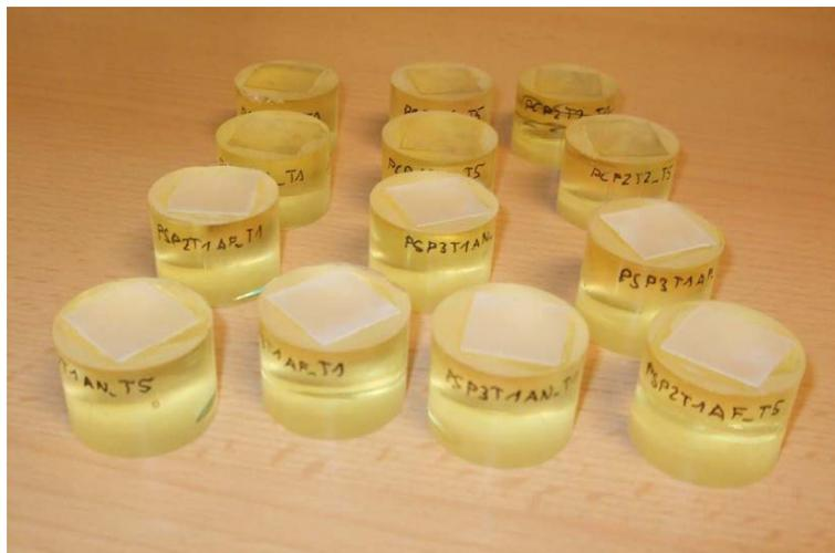
Abb. 97: Aufgeklebte Probekörper auf K unsthazylinder; Poly styrol und Polycarbonat
