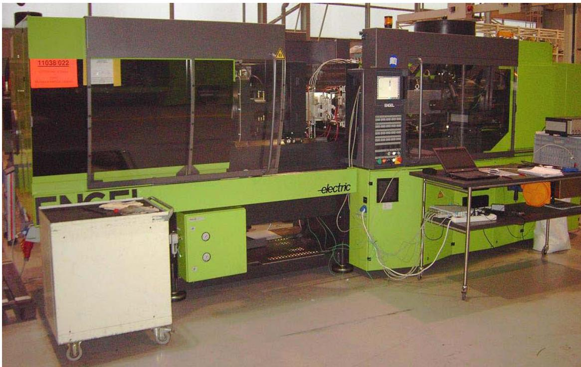
Abb. 25: Spritzgießmaschine Engel Victory 940/130 (Engel Austria GmbH)
