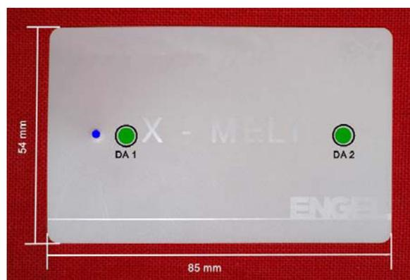
Abb. 28: Scheckkarte mit Abmessungen; A ngusspunkt (blau), Position der Druckaufnehmer (grün)
