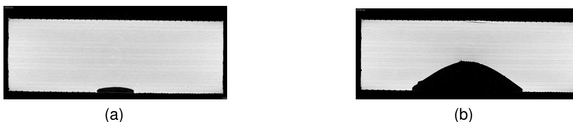
Abb. 4.7: CT- Aufnahmen einer Senkkopfbohrung (a) zu Beginn der Bohrung und (b) ca. in der Mitte der Bohrung (axiale Ansicht).
