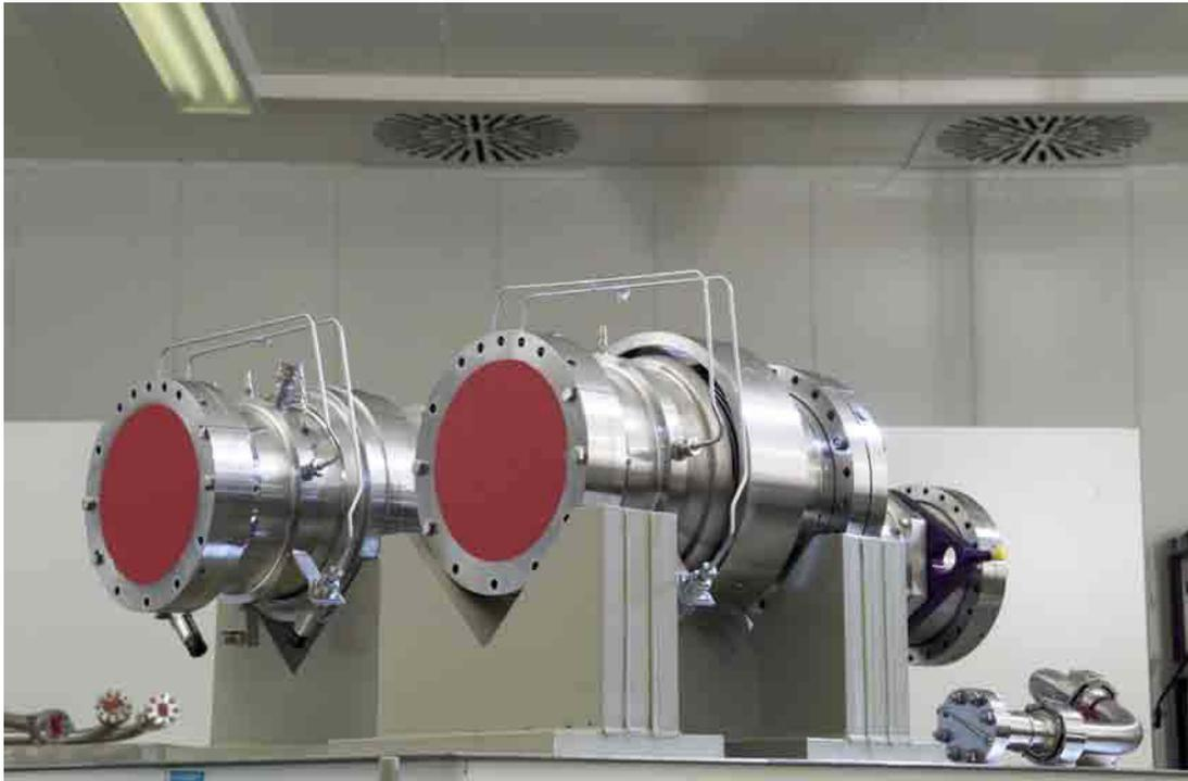
**Abbildung 2.2.:** Kompensatoren in Treibstoffleitungen (Magna Steyr Fahrzeugtechnik AG & Co KG)
