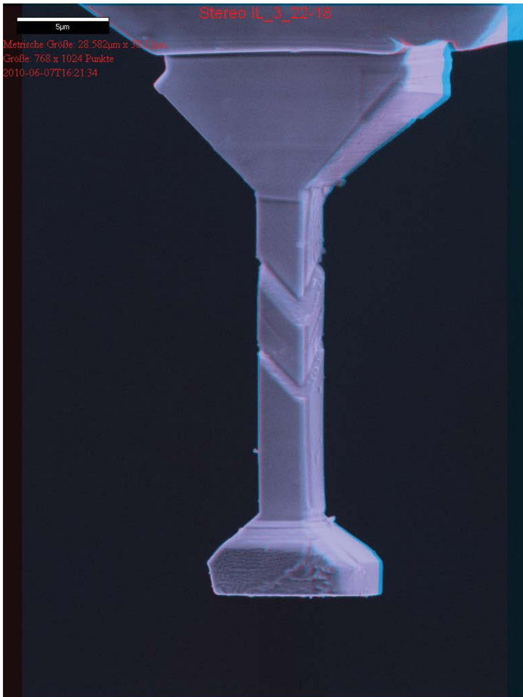
Abbildung 3.9.: Anaglyphbild der Probe P3. Erstellt mit dem Softwarepaket MeX 5.0.1 aus zwei Einzelbildern mit einem relativen Kippwinkel um die Längsachse von 4^\circ . Zur Betrachtung ist die Brille auf der letzten Seite der Diplomarbeit erforderlich. Diese sollte so gehalten werden, dass die grüne Seite über dem rechten Auge liegt.
