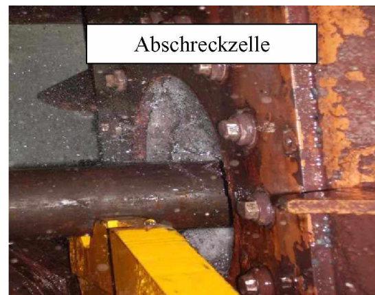
Abbildung 1.3: Wasserquenchanlage bzw. Kühlanlage; Ausfahren des Werkstücks aus dem Härteofen (links), Abschreckzelle im Betrieb (rechts).
