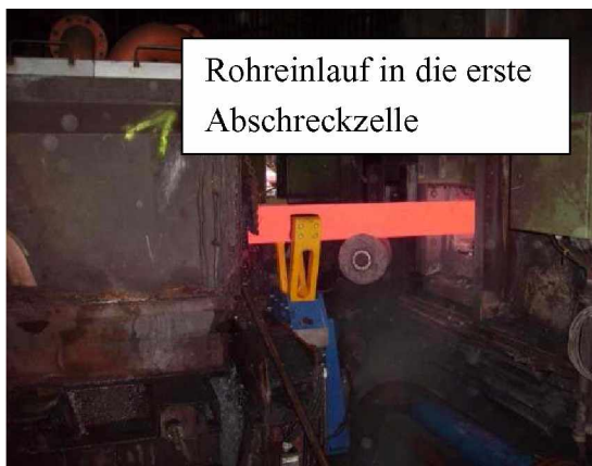
Abbildung 1.3: Wasserquenchanlage bzw. Kühlanlage; Ausfahren des Werkstücks aus dem Härteofen (links), Abschreckzelle im Betrieb (rechts).
