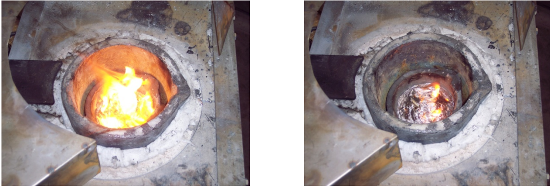
Abbildung 75: Rauchentwicklung beim Einschmelzen des Desoxidationsmaterials „Mechanisch gerollt“
