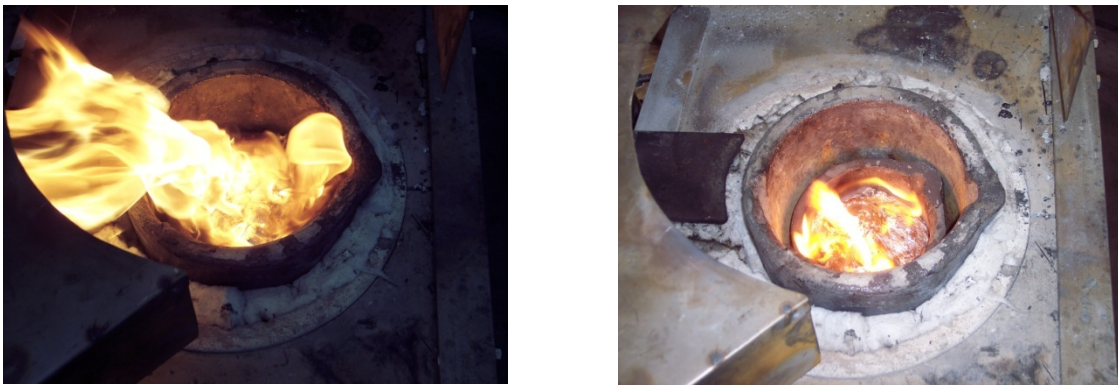
Abbildung 69: Rauchentwicklung beim Einschmelzen des Desoxidationsmittels „Mechanisch verkugelt 1“
