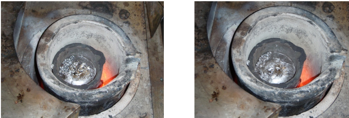
Abbildung 67: Rauchentwicklung beim Einschmelzen des Desoxidationsmaterials „Verhüttet“
