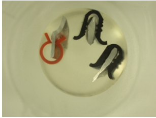
Abbildung 89: Schliffbild „Mechanisch gehackt“_1
