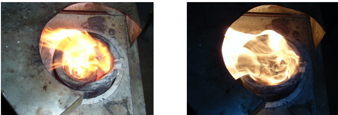
Abbildung 78: Rauchentwicklung beim Einschmelzen vom Material „Mechanisch verkugelt 2“
