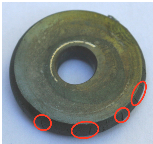
Abbildung 6.7: Mit dem Mineralöl mit Festschmierstoffen als Schmiermittel verpresste Ringtauchprobe bei 600 °C und \varphi = 0,77 .
