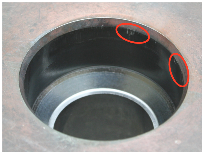
Abbildung 8.8: Kegel-Matrize mit gekennzeichneten Beschädigungen.
