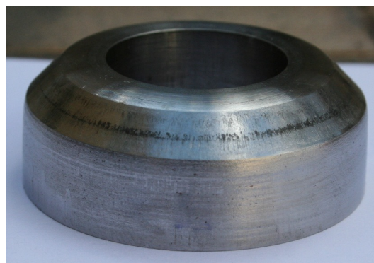
Abbildung 8.5: Bei 20 °C weggesteuert verpresste Zylinderprobe.
