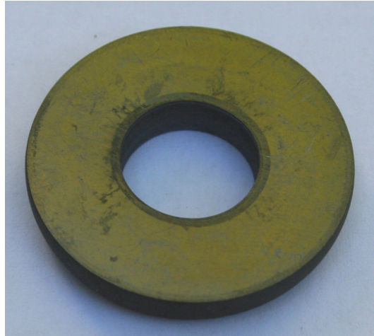
Abbildung 6.4: Mit MoS 2 -Grafitsspray als Schmiermittel verpresste Ringstauhauchprobe bei 600 °C und \varphi = 0,81 .
