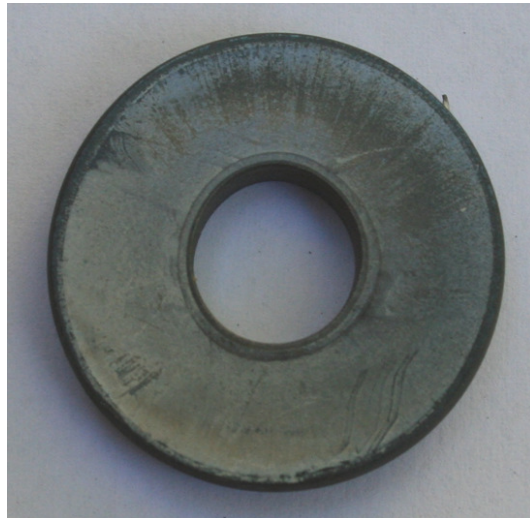
Abbildung 6.6: Mit dem Beschichtungsmittel auf Bornitrid-Basis als Schmiermittel verpresste Ringtauchprobe bei 600 °C und \varphi = 0,82 .
