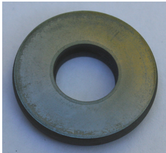
Abbildung 6.5: Mit Grafit-Gleitlack als Schmiermittel verpresste Ringstauhauchprobe bei 600 °C und \varphi = 0,78 .
