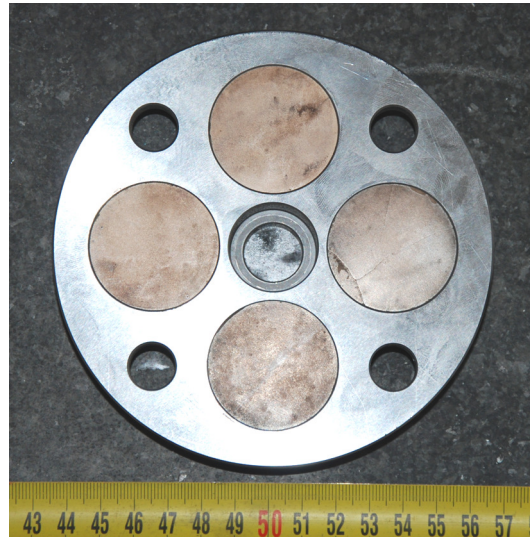
Abbildung 7.3: Stempereinrichtung mit Keramikscheiben.
