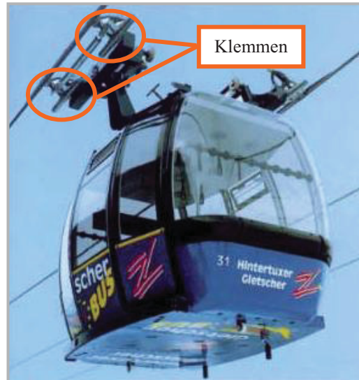
Abb. 3.20: Bild einer Doppel- Einseilbahn (15)
