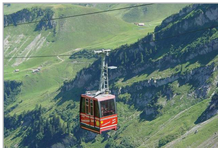
Abb. 3.19: Beispiel einer Einseil-Pendelbahn mit einem Seil (14)
