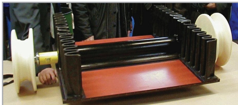
Abb. 3.6: Detailbild der Laufrollenbefestigung am Gurt (9)
