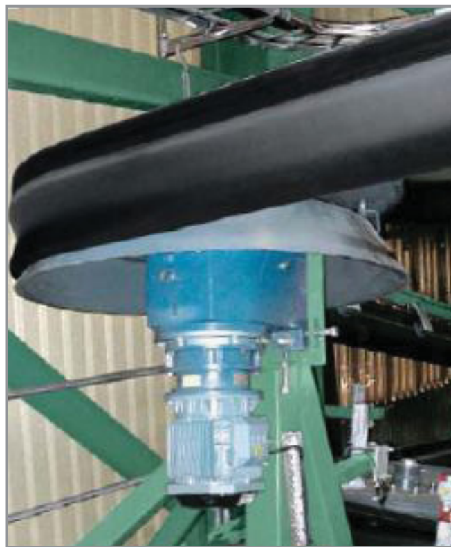
Abb. 7.1: Umlenkung eines SICON- Gurtes mit Antrieb (29)
