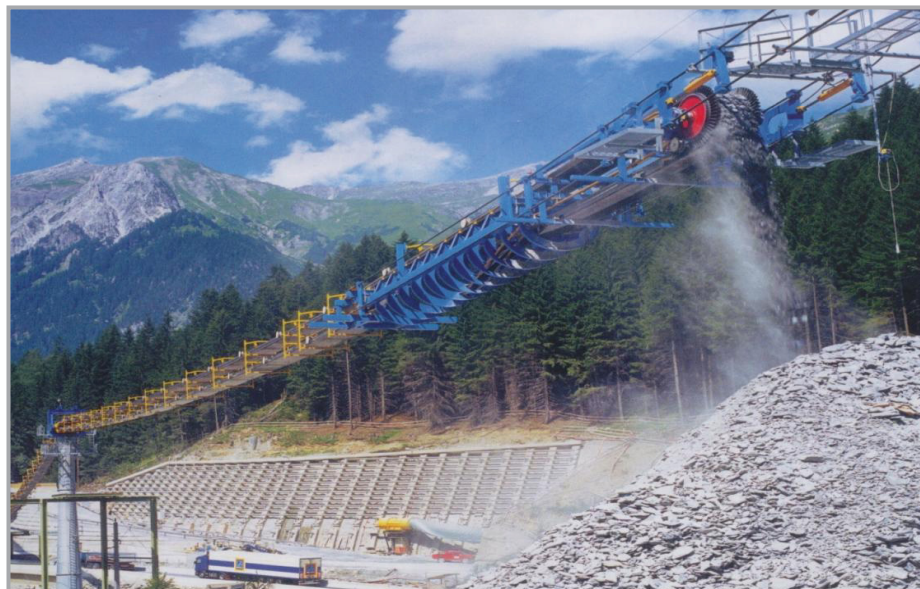
Abb. 3.9: Abwurf des Schüttgutes im freien Fall (2)
