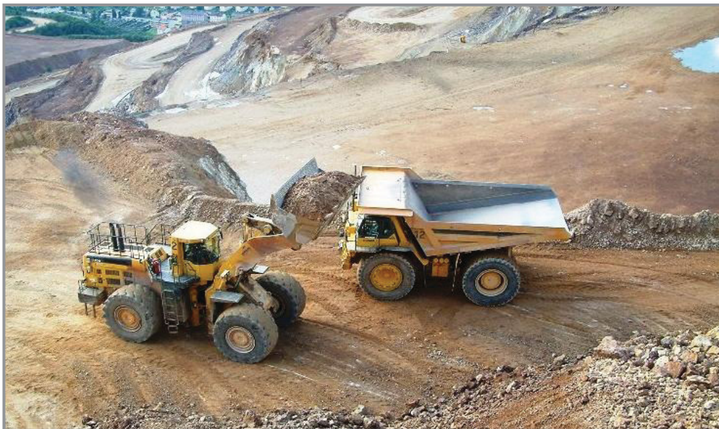
Abb. 3.1: Förderung des Schüttgutes mit SLKW (5)
