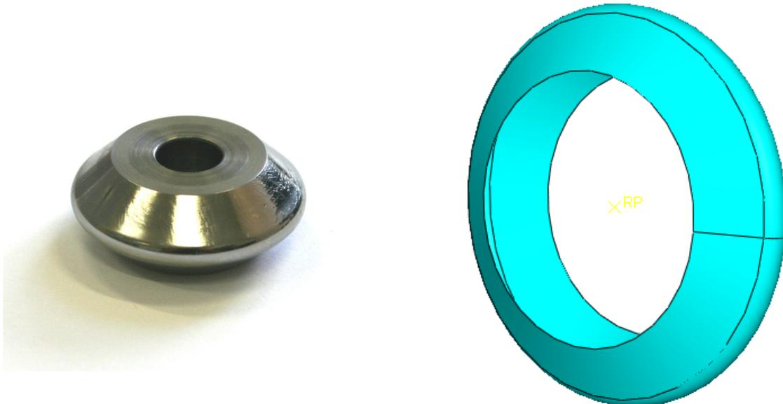
Abb. 6.7: Bild der Walze und als *analytical rigid surface*
