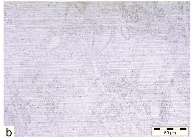
**Abb. 3.31:** Gefüge M333IP, 1020°C Austenitisierungstemperatur, Abkühlung in Öl
