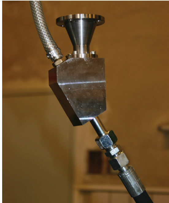
Abb. 6.5: Übergabedüse mit Förderschlauch, Übergabetrichter und Gasschlauch
