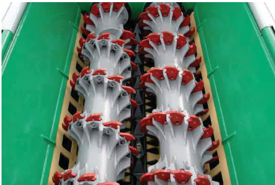
Abb. 1.1: Blick in den Zerkleinerungsraum eines Zweiwellenzerkleinerers [1]
