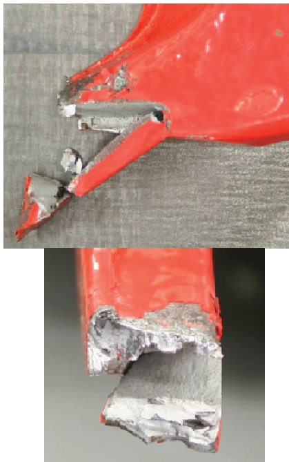
Abb. 9.12: Versagensbilder der Zähne nach der Kurzzeitfestigkeitsuntersuchung [25]
