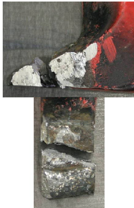
Abb. 9.12: Versagensbilder der Zähne nach der Kurzzeitfestigkeitsuntersuchung [25]
