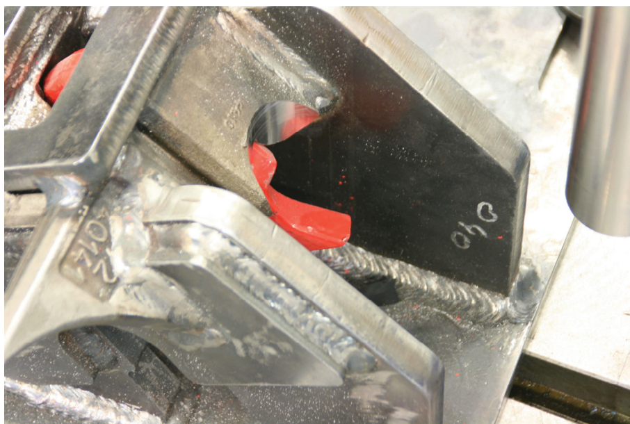
Abb. 9.8: Einspannvorrichtung des Sichelzahns [25]
