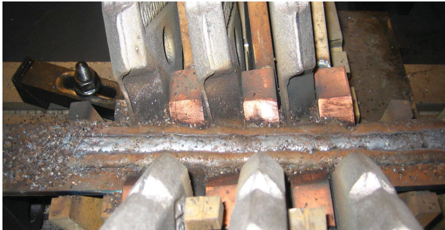
Abb. 7.21: UTP A DUR 650 aufgepanzerzte Sichelzähne mit Karbideinstreuung, Proben-Nr.: 84
