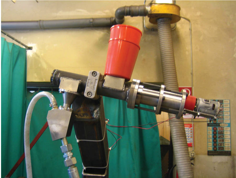
Abb. 6.8: Fördereinheit mit Antriebsmotor auf Konsole montiert
