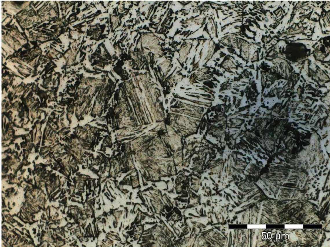
Abb. 3.4. Schlibbild der vereinzelt von einem Ferritsaum umschlossenen ursprünglichen Austenitkörner des untersuchten Stahls; der mittlere Korndurchmesser beträgt \bar{d}^\gamma \approx 20\ \mu\text{m} . Durch die rasche Abkühlung ist nahezu 100% Martensit entstanden.
