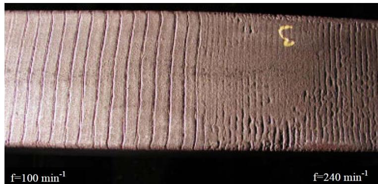
**Abbildung 2-18:** Reduzierung der Tiefe von Oszillationsmarken durch die Erhöhung der Oszillationsfrequenz von  $100 \text{ min}^{-1}$  auf  $240 \text{ min}^{-1}$  [72]
