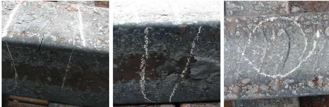
**Abbildung 2-11:** Risse an der Knüppeloberfläche: (a) Querriss am Kantenbereich, (b) Querriss in der Strangmitte, (c) tiefe Oszillationsmarken [101]
