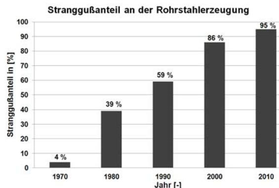
**Abbildung 2-1:** Stranggussanteil an der Weltrohrstahterzeugung [1]
