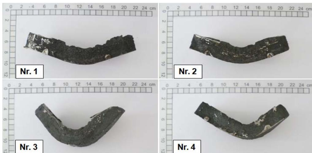
Abbildung 4-39: Proben nach dem Biegeversuch
