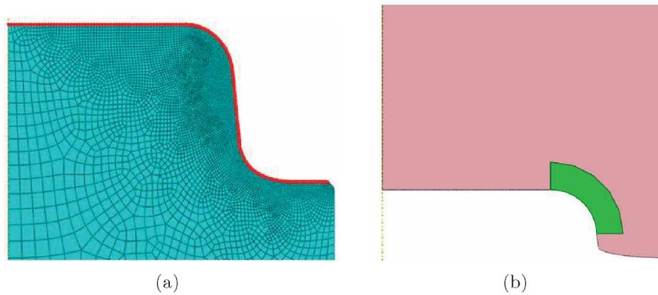
Abbildung 3.3: Set am Stempel (a) und Partition am verformten Rohling (b)
