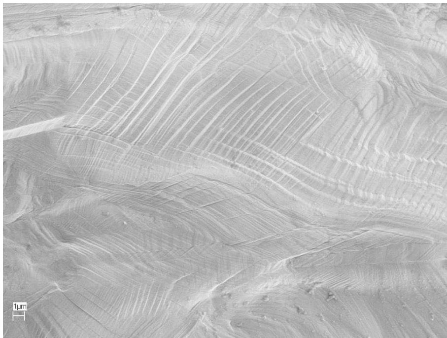
Abbildung 3.4 Oberfläche einer grobkörnigen Zugprobe die bis zum Bruch belastet wurde
