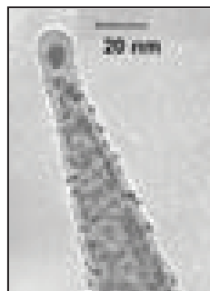
Abbildung 3.4: Elektronenmikroskopische Aufnahme einer Messspitze mit TiN-Beschichtung von NT-MDT [25].
