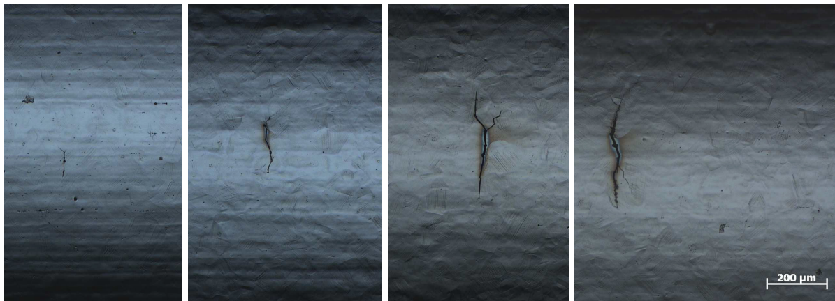
Abbildung 4.8 Risse an der Probenoberfläche von P559 in 129°C 32 % CaCl 2 bei 1,1-facher Belastung über der Streckgrenze nach 1,1 Stunden
