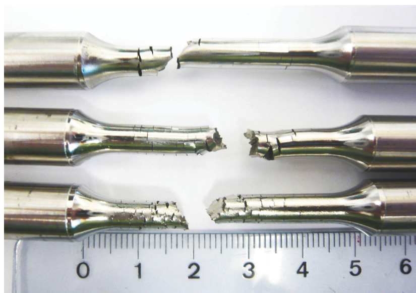
Abbildung 4.7 Proben aus P559 nach Bruch in 129°C 32% CaCl 2 Lösung bei 1,1-facher Belastung über der Streckgrenze
