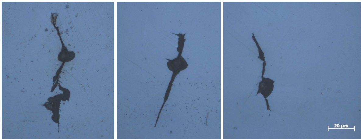
Abbildung 4.15 Oberflächenrisse an P559 in 129°C 32% \text{CaCl}_2 Lösung bei 1,1-facher Belastung über der Streckgrenze nach 0,4 Stunden, aufgenommen mittels Lichtmikroskop mit 100-facher Vergrößerung
