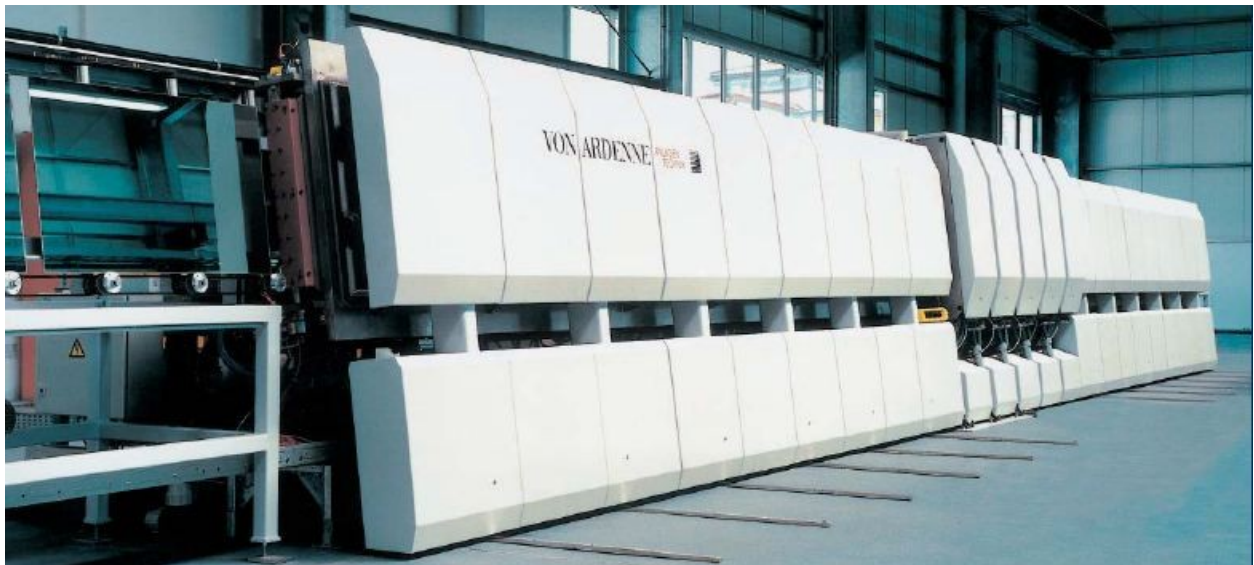
Abbildung 17: Beschichtungsanlage der Firma Ardenne Anlagentechnik [24]
