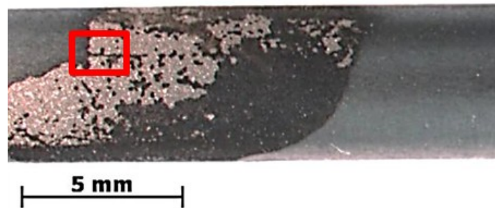
Abbildung 35: Stereomikroskopische Aufnahme von Mo nach 150 Std. Auslagerung in LLW bei 80°C in Kontakt mit PTFE
