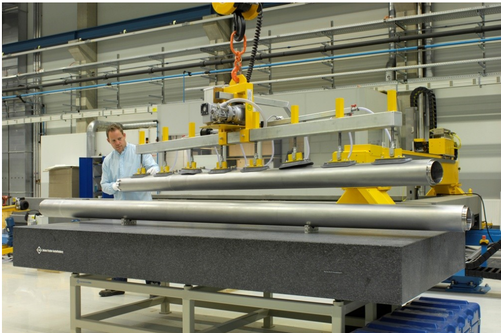
Abbildung 16: Mo-Rohrtargets zur Beschichtung von Solaranlagen
