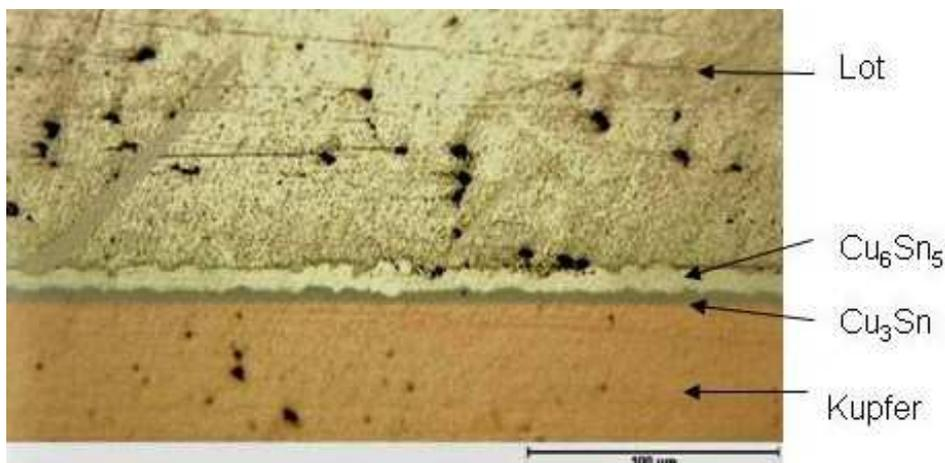
**Abbildung 2.26: Lichtmikroskopischer Querschliff eines SnAgCu-Lot auf einem Kupfersubstrat nach 500 h künstlicher Alterung bei 200 °C [44]**
