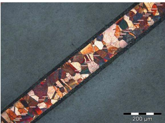
**Abbildung 4.14: Gefügeausbildung von Cu-OF1 bei 7 J/mm<sup>3</sup> Glühleistung**
