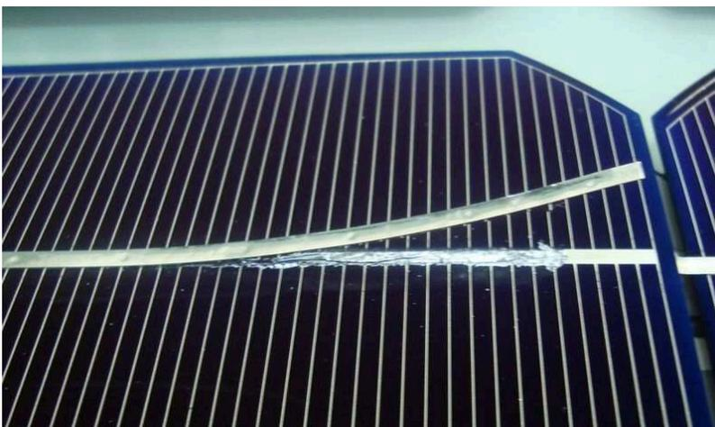
**Abbildung 2.5: Abgehobener Zellverbinder verursacht durch thermomechanische Spannungen beim Löten [11]**
