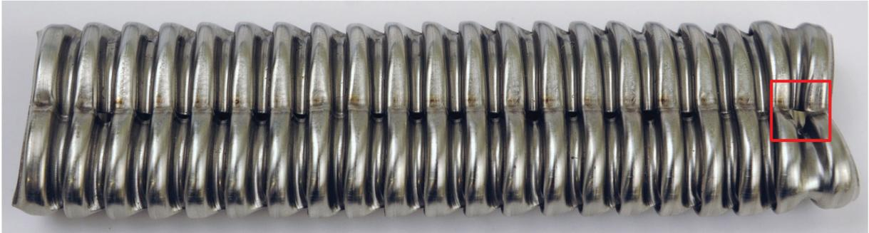
**Abbildung 5.9:** Versagensbild des normalbelasteten Radialprüflings: Rissverlauf entlang der Schweißnaht, rot markierter Bereich stellt die maximal geschädigte Stelle dar.
