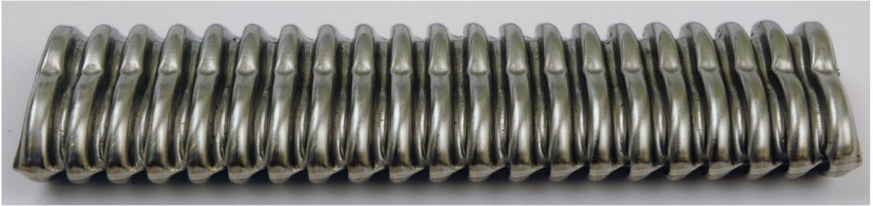
**Abbildung 5.12:** Versagensbild des orthogonalbelasteten Wellrohres: Linienförmige Knickstellen an den Rohrober- und -unterseiten. Keine erkennbaren Risse entlang der Schweißnaht.
