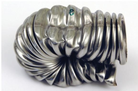
**Abbildung 5.6:** Versagensbild des Stauchversuchsrohres: Vollständig deformiertes Wellrohr, welches um 80 mm axial gestaucht wurde.
