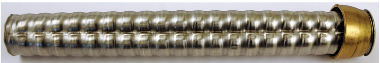
**Abbildung 5.3:** Versagensbild des Zugversuchsrohrs: Lokale Instabilität entlang der Schweißnaht durch axiale Zugbeanspruchung des Wellrohrs.
