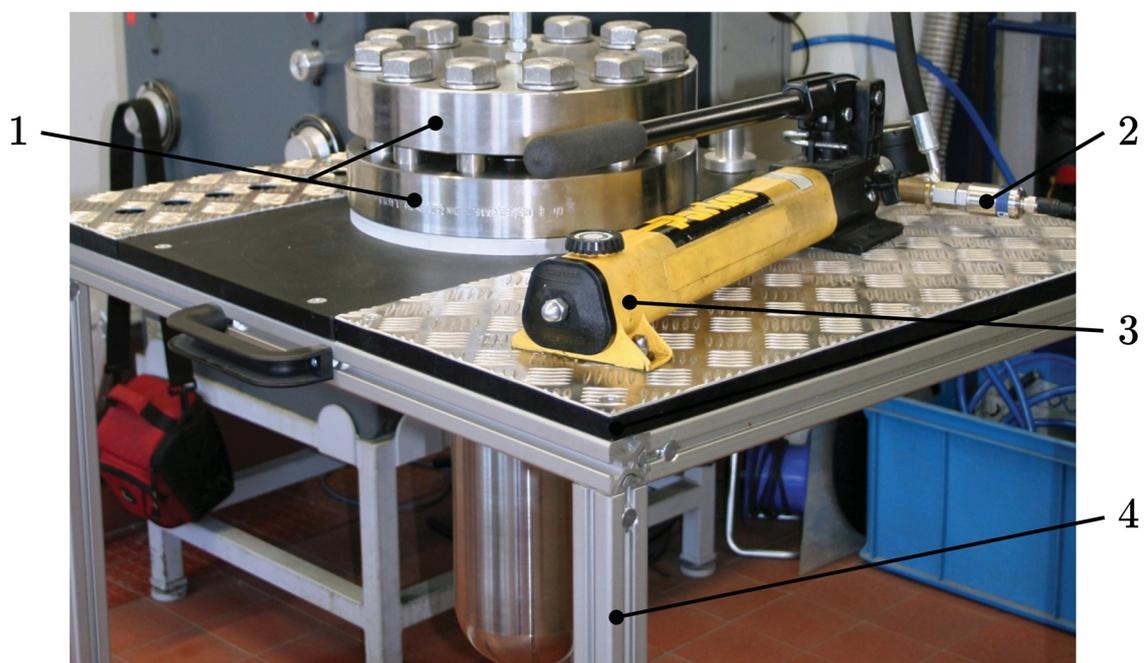
**Abbildung 3.16:** Druckkammer vor Prüfbeginn: Verschlossene Druckkammer vor Beginn der Prüfung. Dargestellt sind die Prüfkammer mit Blindflansch und Schrauben (1), der digitale Druckaufnehmer (2), die Handpumpe (3) und der Untertisch (4).
