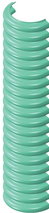
**Abbildung 4.4:** Basismodell des Wellrohrs: Ausgangsmodell mit korrekter Wellrohrgeometrie und einer implementierten Materialeigenschaft für das gesamte Modell.
