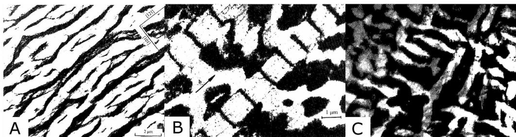
Abbildung 2.10: Typische Versetzungsstrukturen in Bereichen A (Venens-Struktur), B (Persistente Gleitbänder) und C (Labyrinth-Struktur); vergleiche Abbildung 2.9 [17]
