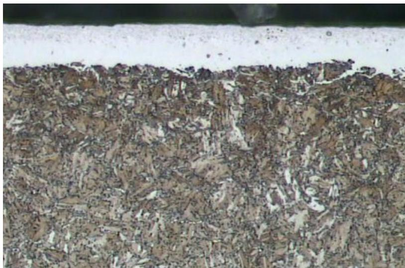
Abbildung 2–7: Lichtmikroskopische Aufnahme einer Nitrierzone [16]
