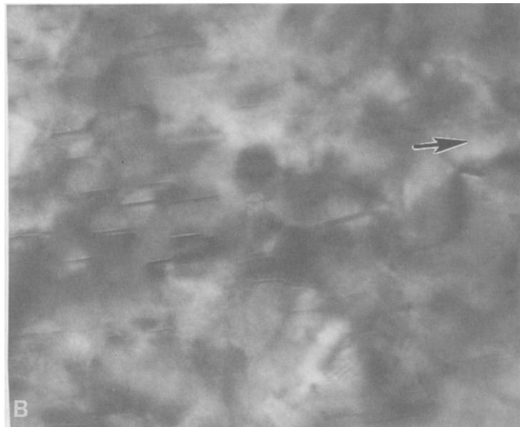
Abb. 2.4: TEM-Hellfeldaufnahme der Aermet 100 Legierung, die bei 482°C für 5 h ausgelagert wurde. Die nadelförmigen Ausscheidungen sind  $M_2C$  Karbide. Der Pfeil zeigt in die [100] Richtung der martensitischen Matrix [2].
