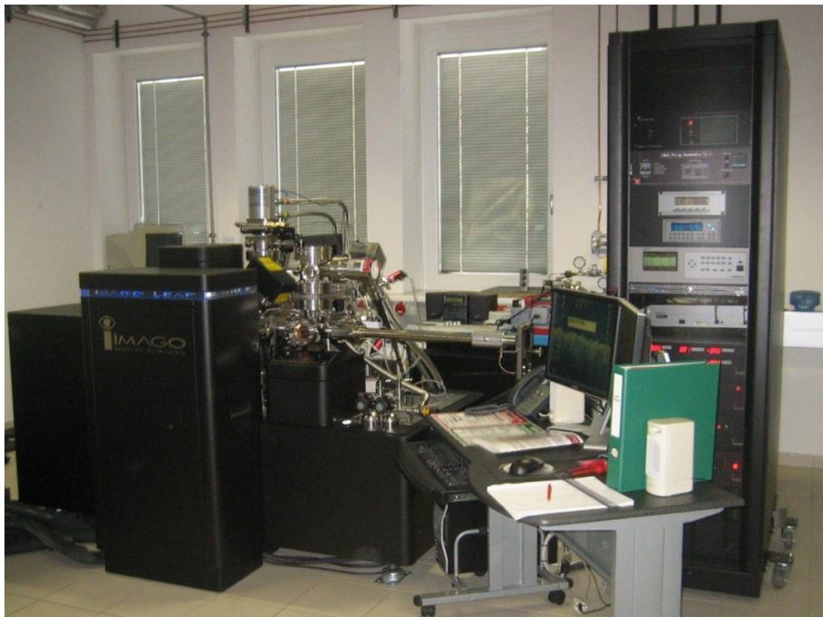
Abb. 3.5: Atomsonde am Department Metallkunde und Werkstoffprüfung
