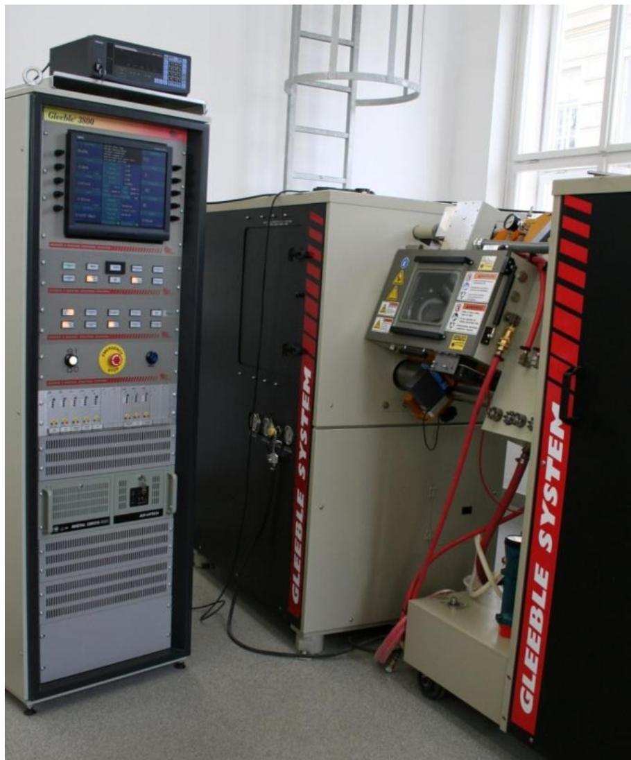
Abbildung 32: Thermomechanische Prüfmaschine Gleeble 3800 der Firma DSI.
