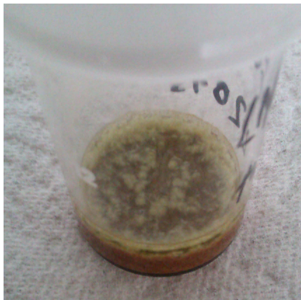
Abbildung 5.2: Fällungen im LNF64-Precursor deuten auf eine instabile Lösung hin
