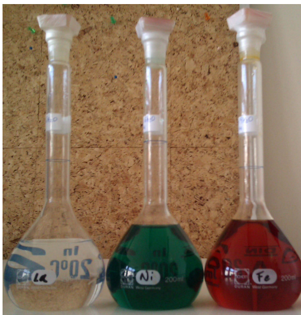
Abbildung 5.4: Wässrige Lösungen der Nitratsalze \text{La}(\text{NO}_3)_3 \cdot 6\text{H}_2\text{O} (weiß), \text{Ni}(\text{NO}_3)_2 \cdot 6\text{H}_2\text{O} (grün) und \text{Fe}(\text{NO}_3)_3 \cdot 9\text{H}_2\text{O} (rotbraun); Konzentration jeweils ca. 1 mol/l
