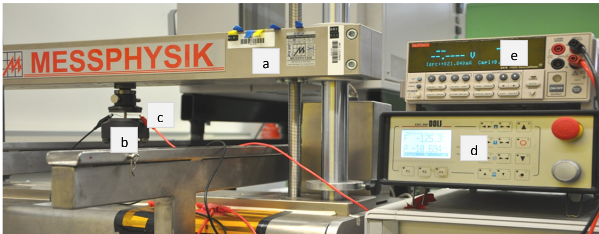
Abb. 14: Messaufbau für die druckabhängige Prüfung der Energievaristorteile. Spindelprüfmaschine mit beweglichem Querhaupt (a), \text{Si}_3\text{N}_4 -Stempel (b), Probe (c), Mess- und Steuereinheit (d) und SMU (e)
