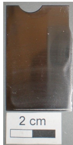
Abbildung 18: Geschliffenes und poliertes ARMCO-Eisen-Plättchen mit den Abmessungen 50 x 30 x 1 mm
