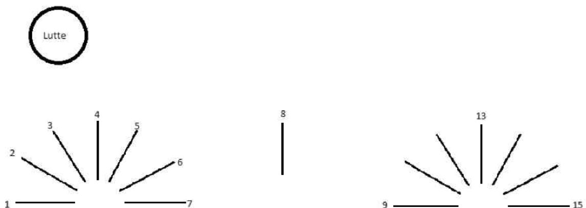
Abb. 5-55: BBT: Skizze: MP2: Flügelradanemometer: Lage der Messungen ohne Betrieb: Vom Boden aus
