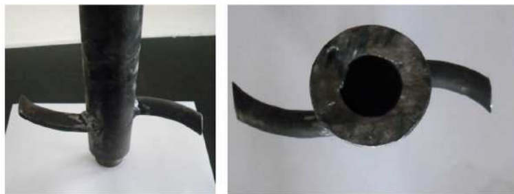
Abbildung 4-12: strömungstechnisch optimierte Tauchlanze [103]
