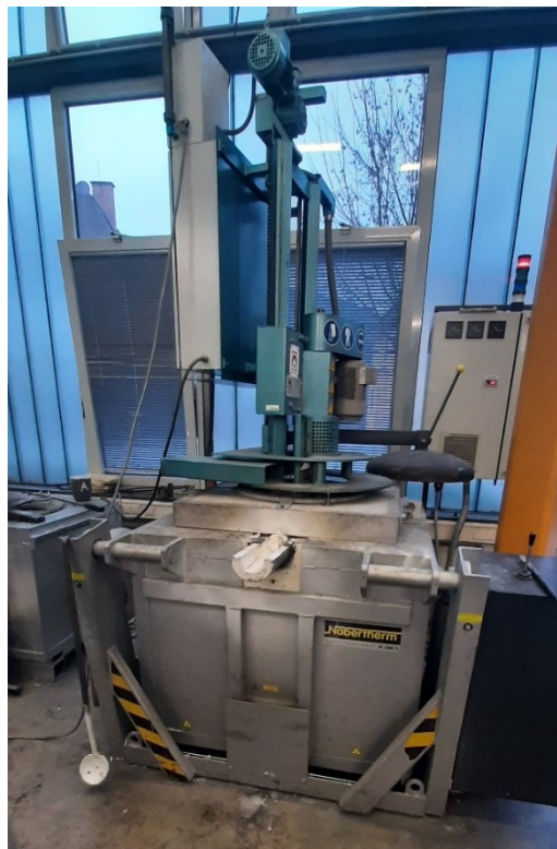
Abbildung 3-1 Ofen KF 40/12 mit Impellerentgaser Foseco FDU Minidegasser 200L.
