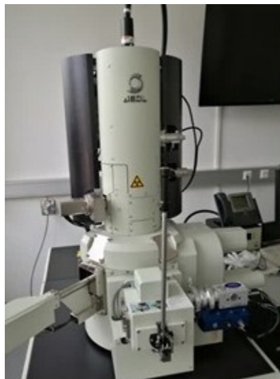
Abbildung 3-12 Verwendetes REM JSM-7200F.
