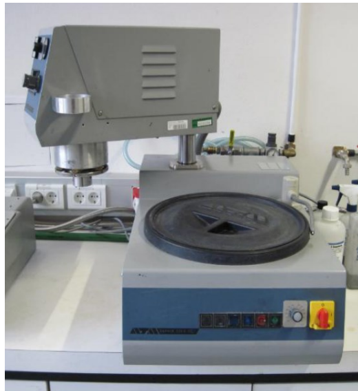
Abbildung 3-7 Schleif- und Poliermaschine ATM Saphir 350.
