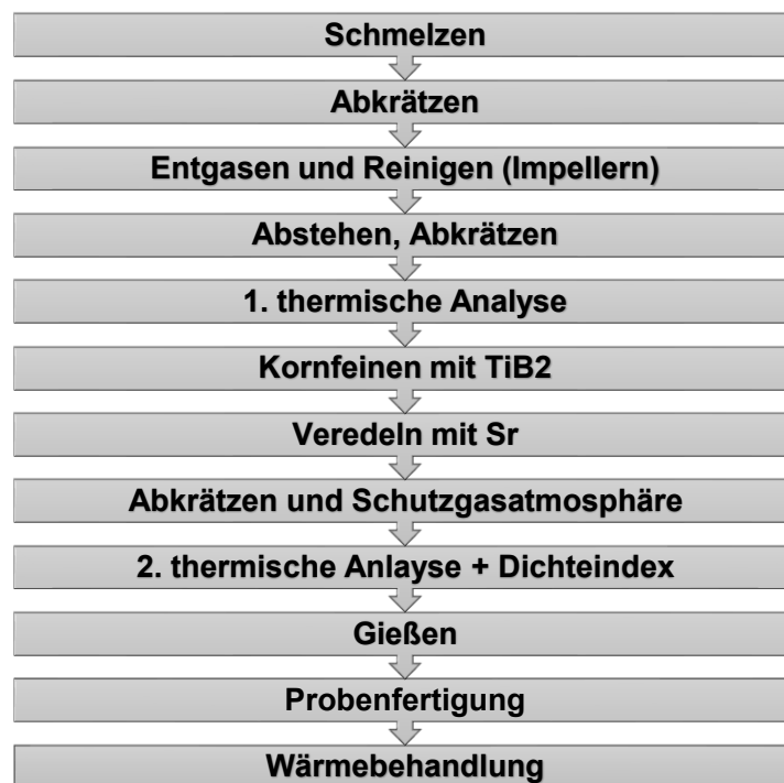
Abbildung 3-2 Arbeitsfolge für die Probenherstellung.
