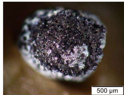
Abb. 58: Si<sub>3</sub>N<sub>4</sub>-Elektrode nach Betrieb im ATR (Front-View, abgerundet)
